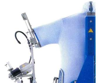
Schnelles, energieeffizientes Trocknen der Knopfleiste durch **VEIT Direct Airflow\***. Für eine optimale Trocknung sorgen die spezielle Luftführung sowie das leistungsstarke Gebläse.
